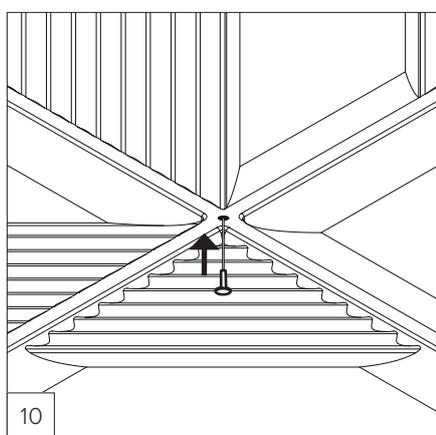
Infila ora il cavo con terminale a bottone nel foro centrale del pannello. Ripeti l'operazione per ogni foro centrale.
