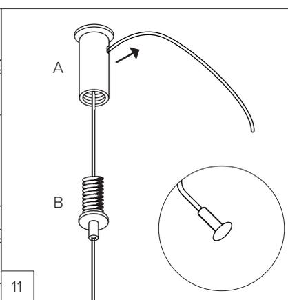
Inserisci i cavi con terminale a bottone prima nell'elemento B e poi nell'elemento A (precedentemente fissato a soffitto) come riportato in figura, mantenendo 10 cm minimo di eccedenza.
