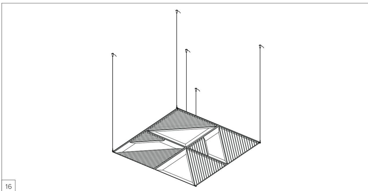
Corretto posizionamento. In esempio è visualizzato il formato C4. La procedura è la medesima per ogni formato di Skin Ceiling.
