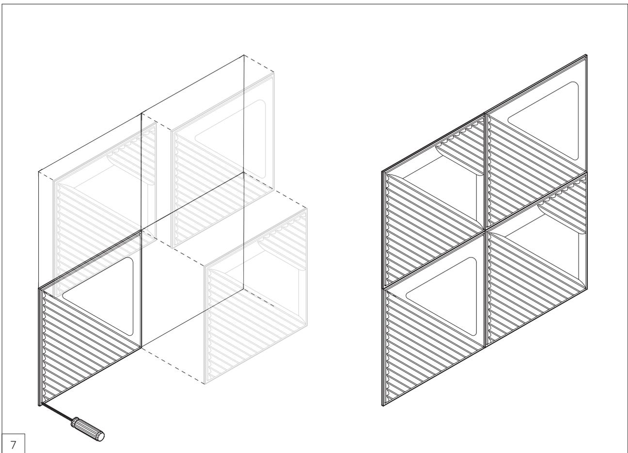
7 Ripeti le operazioni per ogni pannello della composizione, utilizzando come dima i pannelli già posati. In esempio è visualizzata una composizione composta da 4 pannelli.
